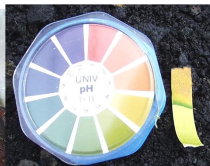
酸性硫酸塩土壤により酸性水が発生した例。湧出する地下水はpH3！
