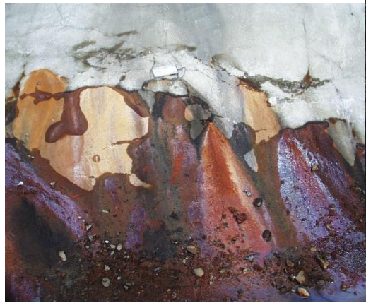
酸性硫酸塩土壤により酸性水が発生した例。湧出する地下水はpH3！
